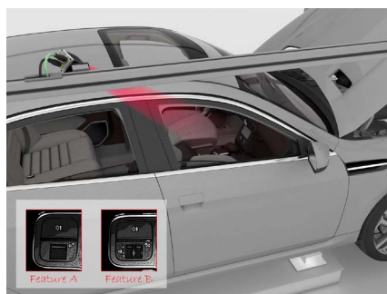
KONTROLA SPRÁVNÉHO TYPU SPÍNAČŮ NA PŘÍSTROJOVÉ DESCE
