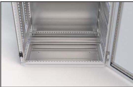
50mm prostor od země ke spodní hraně dveří umožní instalaci rozvaděče bez podstavce díky speciálně navrženému spodnímu rámu. Toto řešení nezmenšuje prostor pro vnitřní instalace.
