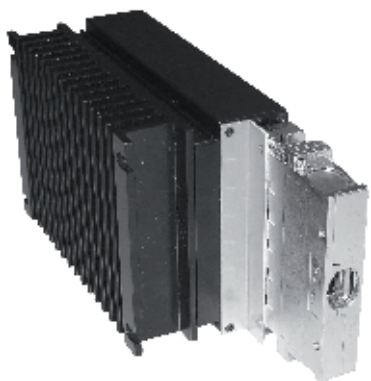
Kovový kryt konektoru zaručuje protipožární ochranu
