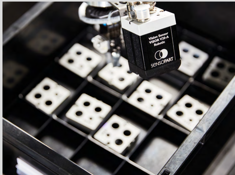
VISOR® Robotic detekuje polohu součástí v univerzálním zásobníku předtím, než může být poté spolehlivě vyjmuta. Při využití až 255 možných kombinací lze dosáhnout vysokého stupně flexibility výrobního procesu.
