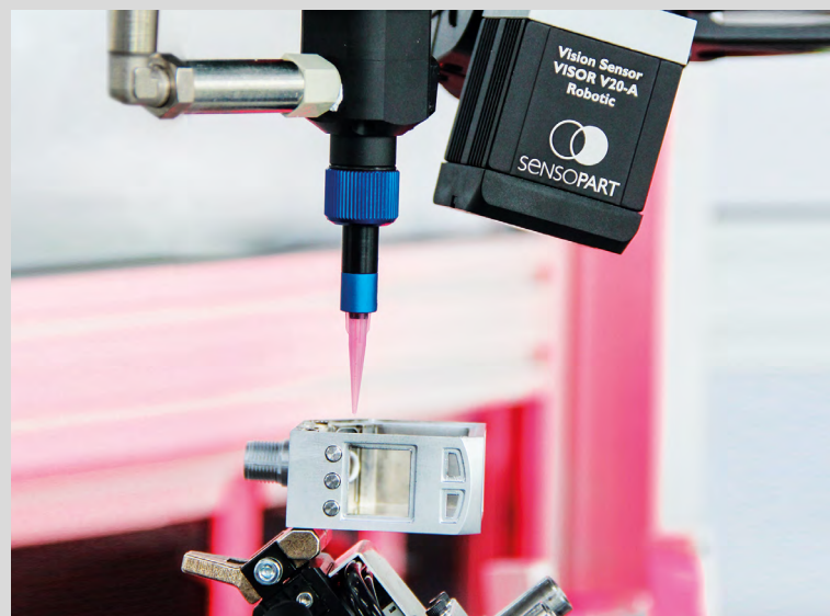
VISOR® Robotic určuje přesnou polohu při obrábění pouzdra snímače. Údaje o posuvu jsou využity ke korekci trajektorie koncového bodu ramene robotu.
