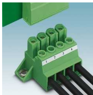
Série PC 6: zástrčka pro přímé upevnění, šroubová svorka, do 41 A, rozteč 10,16 mm PCU 6/... Strana 552
