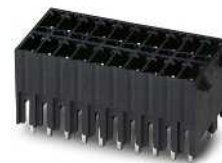
Délka pinu 2,6 mm, s pojistnými západkami, směr zasunutí kolmý k desce plošných spojů
