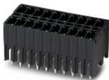
Délka pinu 2,6 mm směr zasunutí kolmý k desce plošných spojů
