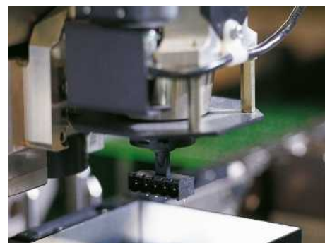
Konstrukční díl na osazovací hlavě
