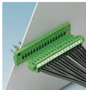
Zásuvka konektorové průchodky, rozteč 3,81 mm, s připojením fastonem DFK-MC 1,5/...-G(F)-3,81 Strana 240
