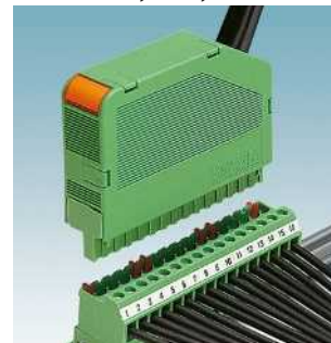
Pouzdro kabelu pro zástrčku se šroubovým připojením, 2 až 24pólové, rozteč 5,0 / 5,08 / 7,5 / 7,62 mm Strana 348
