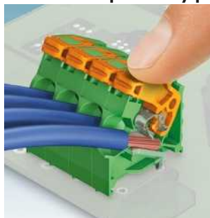
Série PLH 5: pružinová svorka Push-Lock, rozteč 7,5 mm, do 41 A, připojení: 30° k desce pro plošné spoje PLH/A 5... Strana 470
