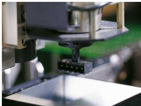
Zaměření kamery pro měření konstrukčního dílu
