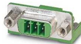
Stíněná zásuvka konektoru POWER SUBCON, pro stěny o síle do 4,5 mm, pojistný závit 4-40 UNC
