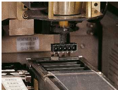
„Pick“ konstrukčního dílu z pásu
