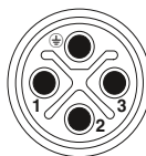
Osazení pólů zástrčky M12, 4pólové, s kódováním S, pohled z kolíkové strany
