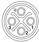
Obsazení pólů zásuvky M12, 4pólové, s kódováním S, pohled ze strany zdířky
