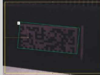
Kód s nízkým kontrastem Kód je čitelný díky vysoké toleranci snímače vůči nízkokонтastním kódům.
