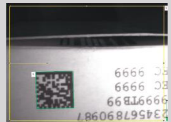
Tištěné kódy na farmaceutických obalech Současně lze vyhledávat a číst 2D maticové kódy dle standardu ECC200 nebo čárové kódy (např. dle EAN 13). Kromě čtení kódů lze pomocí detekce objektů kontrolovat přítomnost optických znaků.
