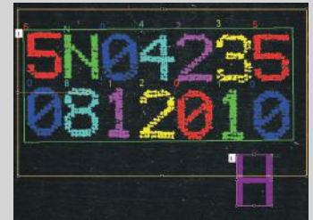
Optické rozpoznávání znaků Pomocí OCR lze číst i bodový potisk.
