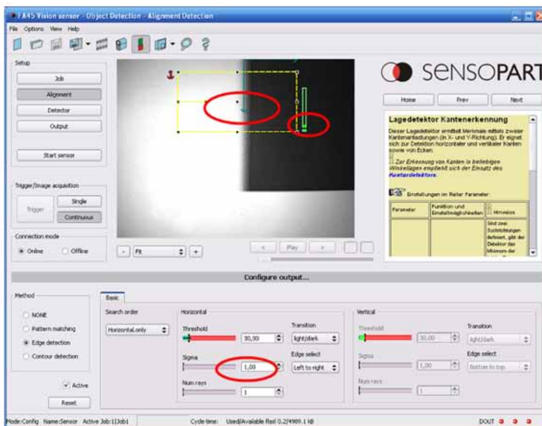
Obr. 235: Rozpoznávání hran – neostrá (rozmazaná) hrana. Malá ostrost hrany s nízkou hodnotou parametru Sigma.
