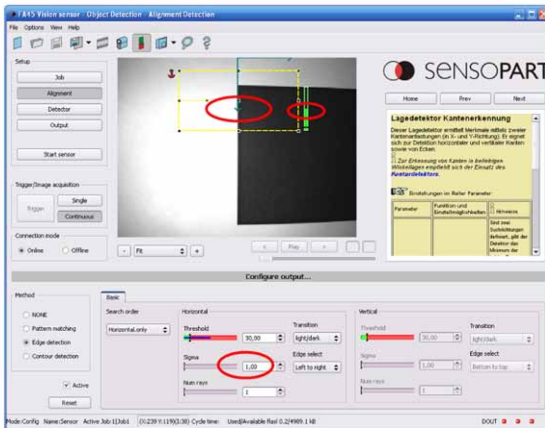
Obr. 234: Rozpoznávání hran – příklad ostré hrany. Velká ostrost hrany s nízkou hodnotou parametru Sigma (vyhlazení).
