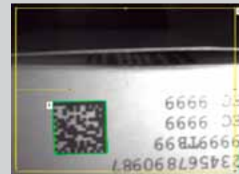
Tištěné kódy na farmaceutických obalech Současně lze vyhledávat a číst 2D maticové kódy dle standardu ECC 200 nebo čárové kódy (např. dle EAN 13). Mimo čtení kódů lze také pomocí detekce objektů kontrolovat přítomnost znaků (písma).
