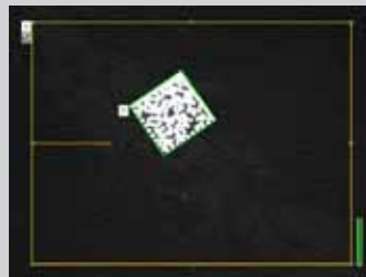
Čtení kódů na solárních člancích Lze číst i kódy velmi malých rozměrů (na křemíkových solárních člancích) nebo vysoce odrazivé kódy (např. na tenkovrstvých solárních člancích).
