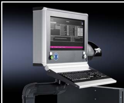
Ovládání stroje klávesnicí a tisk etiket pro přesnou identifikaci přřezů podle projektu
