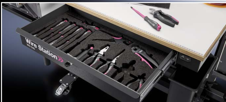
Integrovaná vložka vhodná pro nářadí od společnosti Rittal jako: šroubováky, štípací kleště, krimpovací kleště atd., viz strana 566
